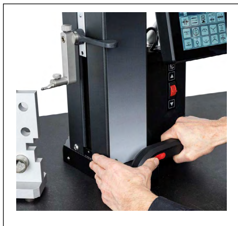
図 8 作動したエアベアリングを使用して、本機器を移動
