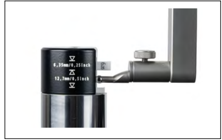
図 13 溝で較正時の設定ゲージの位置決め
