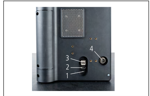
図 10 USBソケット 1 Mini USB 2 1 x USB 3.1 (黒) 3 2 x USB 3.1 (白) 4 8ピン丸型プラグ (コントロールパネル電源用)
